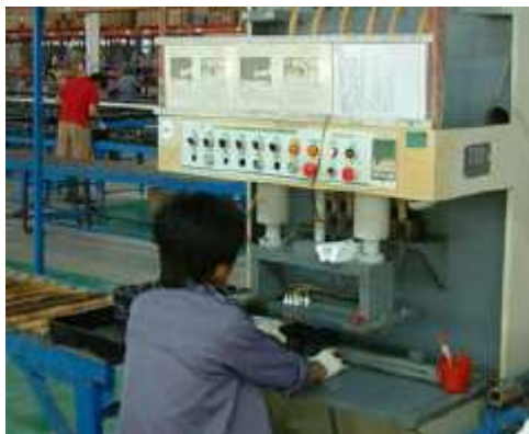
Plnění akumulátoru elektrolytem
